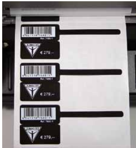
Bild 3: Außer dem Logo, dem Preis, einem Text und der Artikelnummer enthält das Uhrenetikett auch den linearen EAN13-Barcode.
